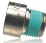
La técnica consiste en recubrir previamente las roscas con una cola microencapsulada que se activa únicamente durante el montaje. Durante el ensamblaje, el adhesivo liberado por la explosión de las microcápsulas se mezcla con el catalizador y encola los elementos roscados entre ellos.
