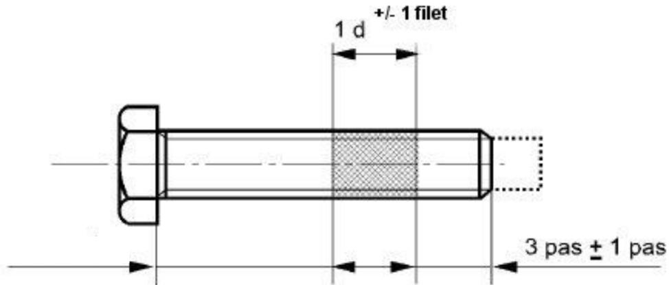
*Remarque :* Lorsque le pas de vis est inférieur à 1.25 et de diamètre inférieur à 8mm, la longueur de pré-
