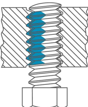
**Le patch Tuflok® est connu pour ses avantages économiques. Il permet de monter plusieurs fois la même vis. Les opérations de maintenance et de démontage sont donc simplifiées et plus économiques.**
